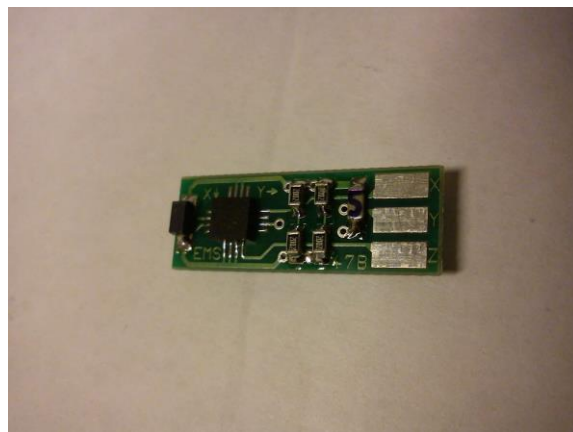
Obr. 5 – Příklad snímače zrychlení typu MEMS včetně desky plošného spoje
