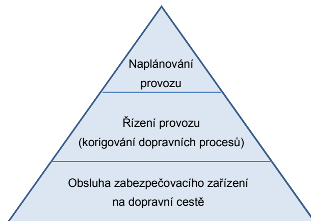
Obrázek 1: Vztah řízení dopravy a obsluhy zabezpečovacího zařízení
