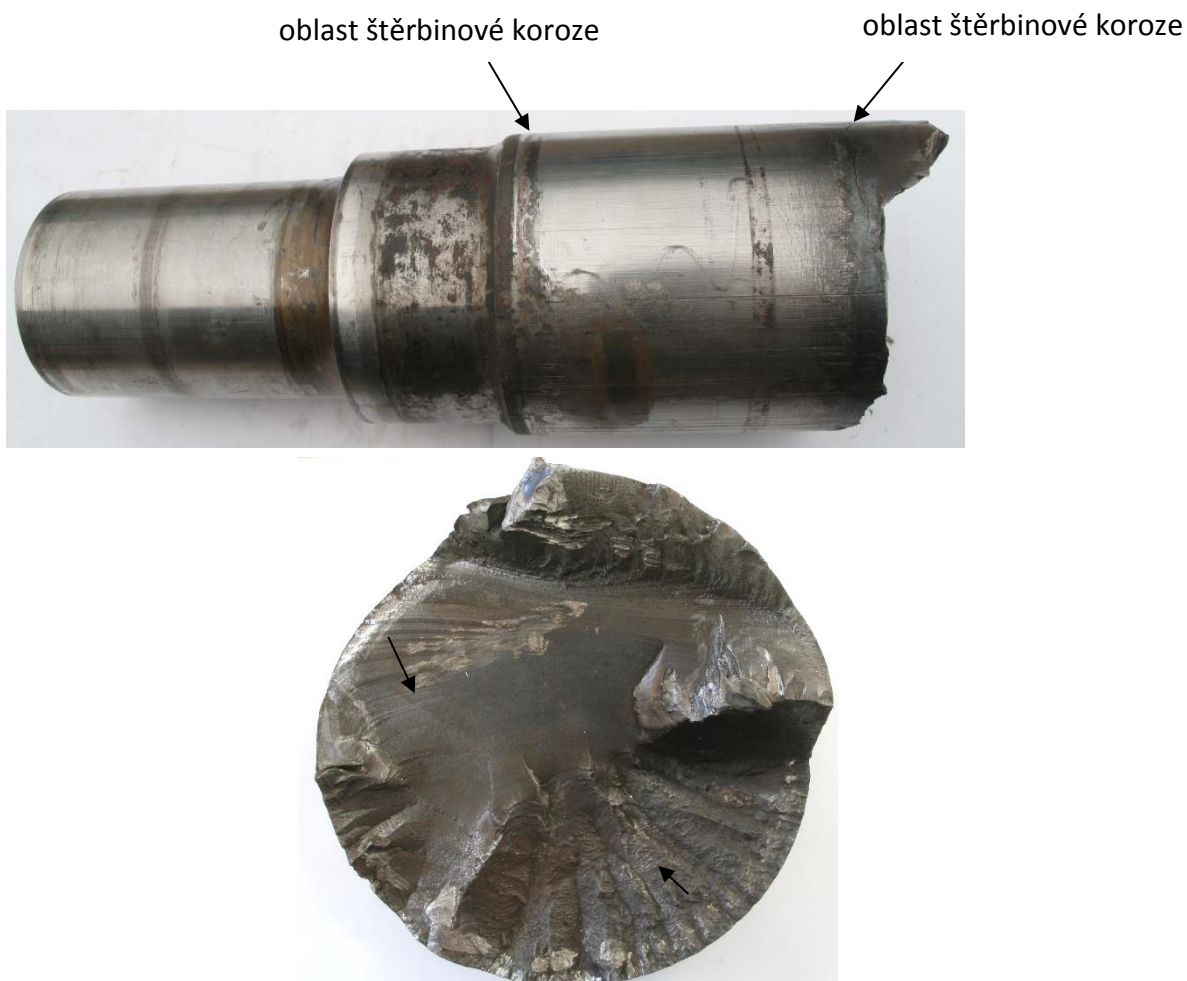
OBR. 1 – příklad únavového lomu nápravy s vyznačením oblastí štěrbinové koroze
