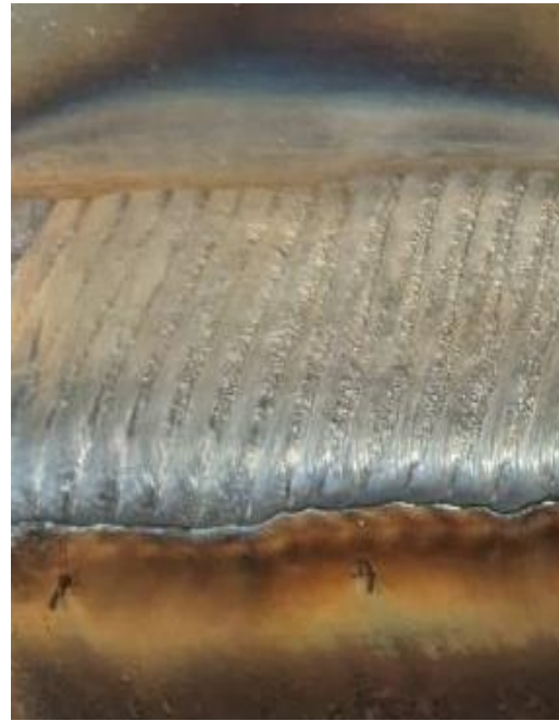
Obr.7 Detail kontaktní vrstvy navařené plazmou
