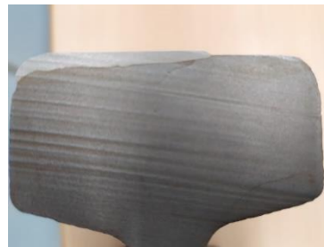
Obr.5 Vytvořená povrchová vrstva v kontaktní ploše kolejnice
