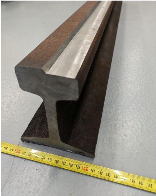
Obr.6 Vytvořená drážka pro navařování kontaktní vrstvy
