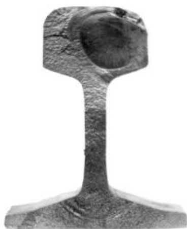
Obr.1 Příklad provozního únavového lomu kolejnice [1]
