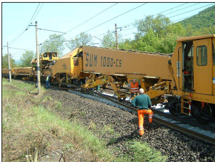
Obr. 3.7 SUM 1000 CS- most stroje s pracovními kleštinami
