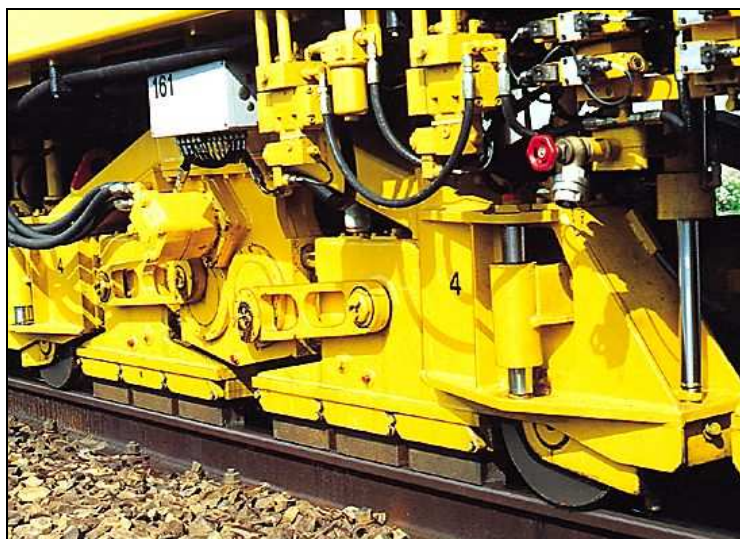
Obr. 3.23 Brousící agregát Plasser s oscilačními brusnými kameny
