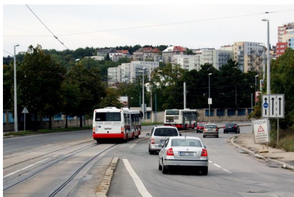
B01 // Provoz autobusů MHD po zvýšeném tramvajovém pásu v Praze v ulici Chodovská.
