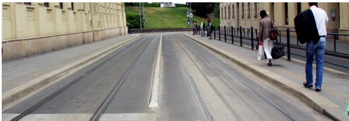
B11 // Příklad umístění podélného prahu v ose tramvajové trati v místě sdružené zastávky (Šilingrovo náměstí, Brno).
