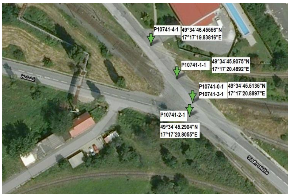
obr.3 Kontrolní ortofotomapa složitého souběhového přejezdu P10741 s údaji o polohách referenčních bodů traťopřejezdů jednotlivých vleček
