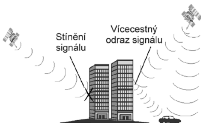
obr. 3 Efekty více-cestného šíření signálů
