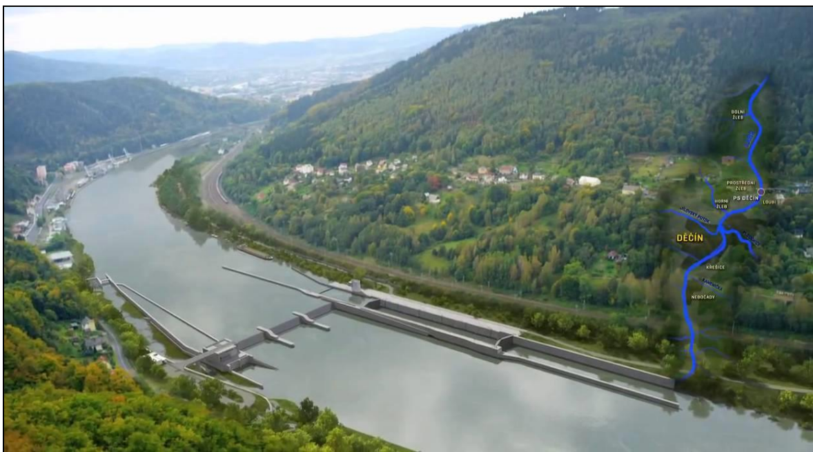
Obrázek. 3.3 Vizualizace PS Děčín - plavební komora, jez, MVE, terestrické migrační pásmo, Zdroj: [48]
